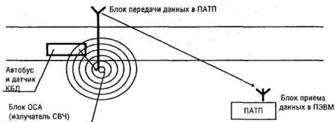
Рис. 28. Принцип работы радиочастотной идентификации
