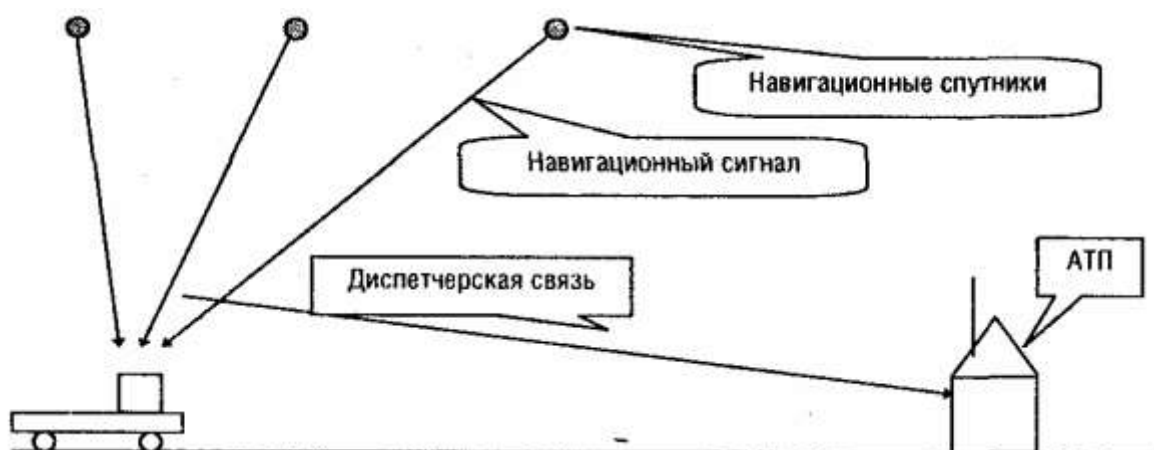
Рис. 29. Принципиальная схема работы спутниковой навигационной системы
